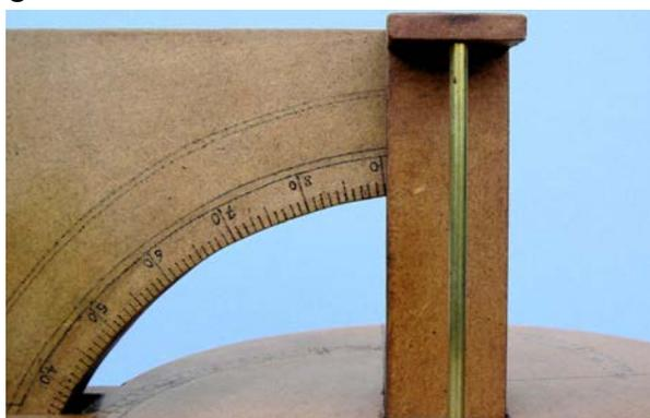
▲ Fig. 8 : Le bras est en position verticale. Le 0 de 90° est visible sur le bord.
