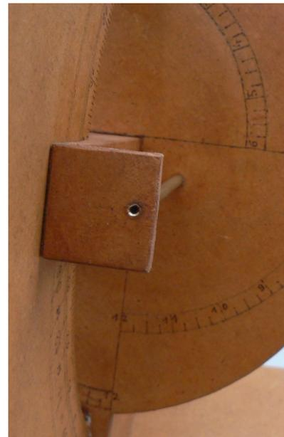
Fig. 13: La pinnule percée d'un trou fin. ►
