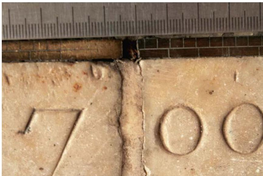
**Fig.1** : Intervalle creusé à la jointure entre deux règles de laiton au niveau de la graduation 700 (égale à 1000 fois la tangente de l'angle zénithal) de la ligne méridienne.
